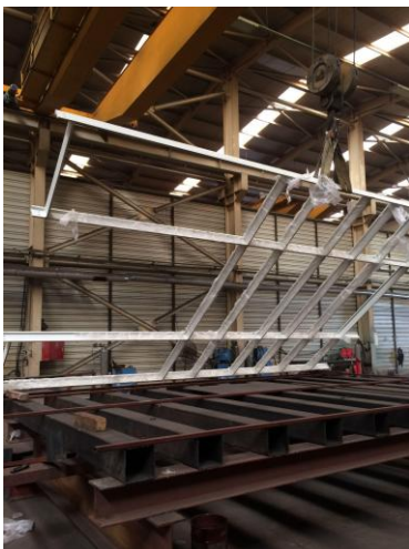
Çelik giydirmce cephe kurgusu / Çelik Bileşenlerin üretim evinde birleştirilmesi ve çerçeve olarak üretilmesi...
