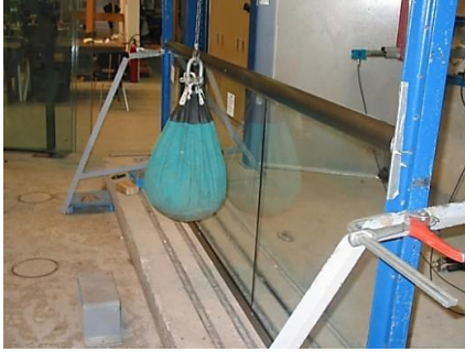
Darbe Dayanım Deneyi / Örnek Görüntü
