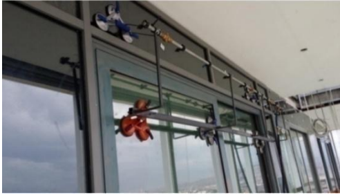
Saha Su Geçirimsizlik Deneyi – Doğrama Birimi
