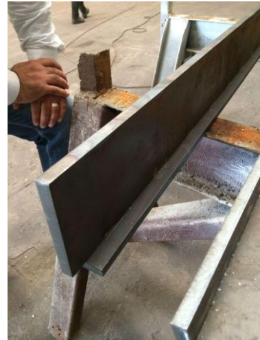
Kaynak için açılan boşluklar görünmeyen yüzde kalmalıdır. Kaynaklama işlemi tamamlandıktan sonra düzgün yüzey oluşmalıdır
