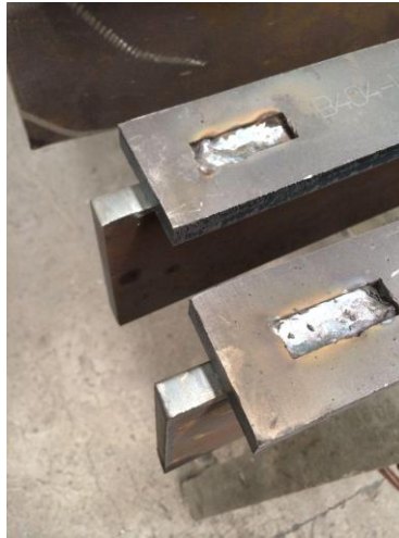
Kaynak için açılan boşluklar görünmeyen yüzde kalmalıdır. Kaynaklama işlemi tamamlandıktan sonra düzgün yüzey oluşmalıdır
