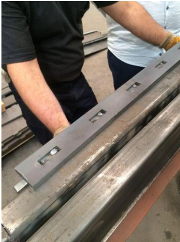
Kaynak için açılan boşluklar görünmeyen yüzde kalmalıdır. Kaynaklama işlemi tamamlandıktan sonra düzgün yüzey oluşmalıdır
