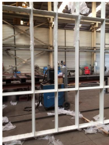
Çelik giydirmce cephe kurgusu / Çelik Bileşenlerin üretim evinde birleştirilmesi ve çerçeve olarak üretilmesi...
